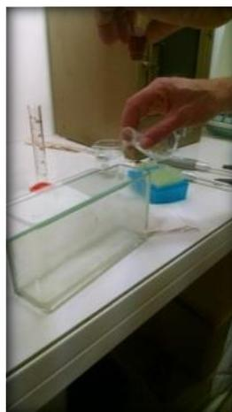
Figura 14 y 15: Colocación de solución de arrastre en cuba y saturación
