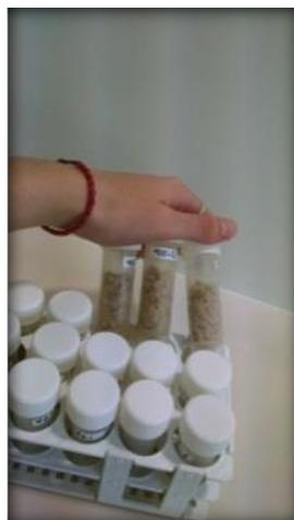
Figura 10: Colocación de muestra en tubos de propileno.
